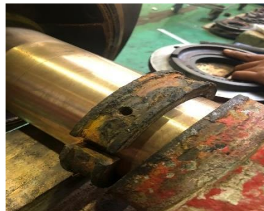
Gambar 4.6 Kondisi Lantern ring yang akan diganti (Sumber : PT.Chandra Asri Pacific)
