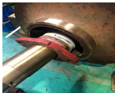
Gambar 4.7 Kondisi Setelah pergantian lantern ring baru (Sumber : PT.Chandra Asri Pacific)
