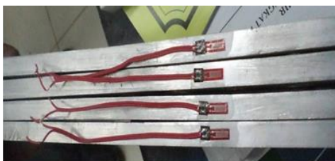
Gambar 4. Pemasangan strain gauge pada balok
