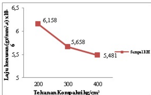
Gambar 11. Grafik pengaruh tekanan kompaksi terhadap laju keausan.
