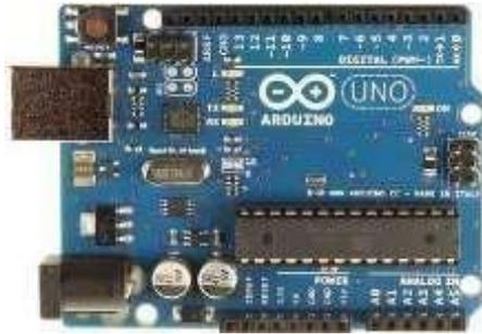
Gambar 2. Arduino UNO ATmega328
