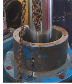
Gambar 4.13 Pemasangan Piston Rod
