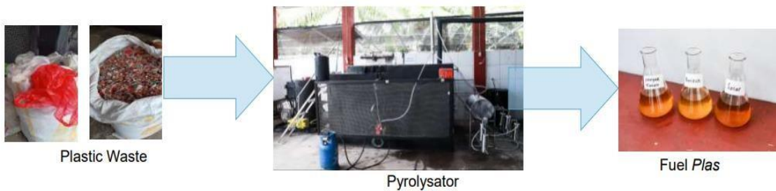
Gambar 6.11 Proses konversi sampah plastik menjadi bahan bakar cair
