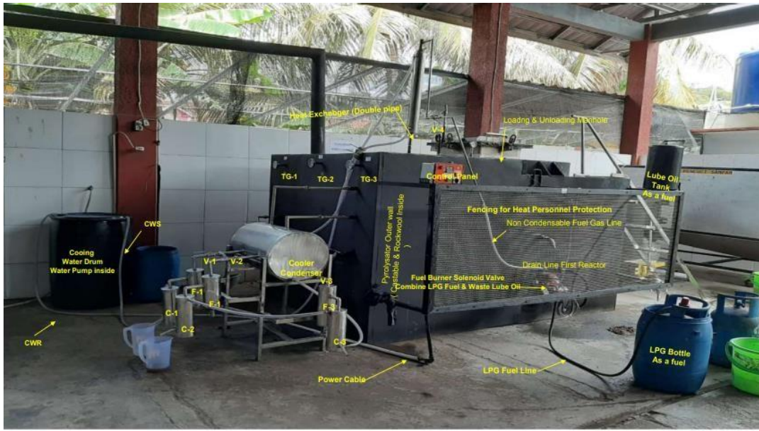
Gambar 6.9 Rangkaian Alat Pirolisis Sampah Plastik
