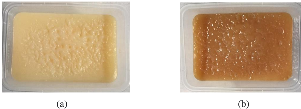
Gambar 4.5 Selulosa bakteri dari (a) limbah cair tepung aren dengan Acetobacterium xylinum 15%; (b) limbah cair aren dengan Acetobacteri xylinum 20%
