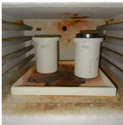
Gambar 3. 6 Proses Reduksi Langsung
