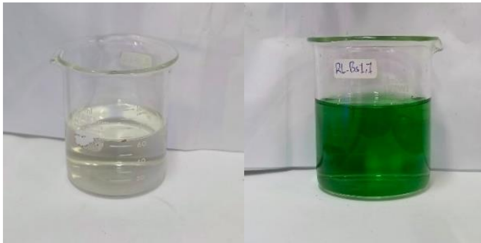
Gambar 3. 16 Proses Uji Fe Metal Sebelum dan Sesudah Proses Titrasi
