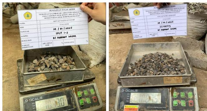
Gambar 5.2 Pengujian berat jenis agregat kasar
