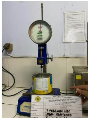
Gambar 5.7 Pengujian penetrasi aspal
