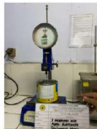
Gambar 5.7 Pengujian penetrasi aspal (Sumber : Dokumentasi penulis, 2025)
