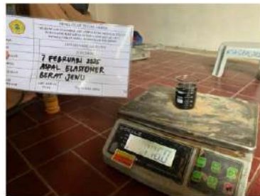
Gambar 5.9 Pengujian berat jenis aspal
