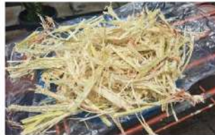
Gambar 4.1 Proses pengeringan ampas tebu
