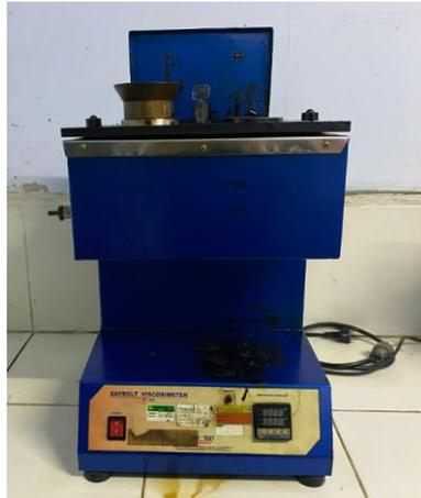
Gambar 5.13 Mesin viskositas aspal
