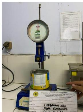
Gambar 5.7 Pengujian penetrasi aspal
