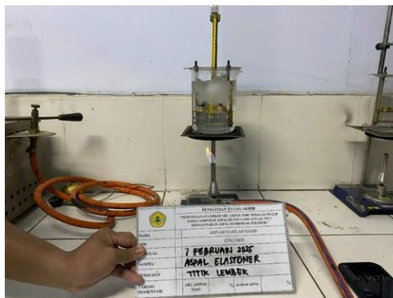
Gambar 5.10 Pengujian titik lembek aspal
