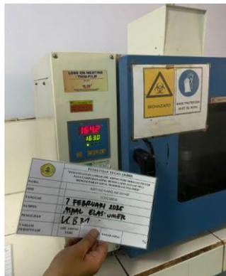
Gambar 5.8 Pengujian kehilangan berat minyak dan aspal
