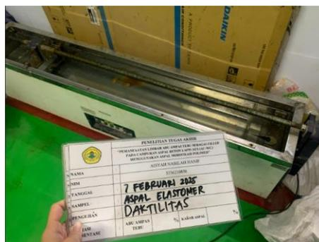
Gambar 5.12 Pengujian daktilitas aspal
