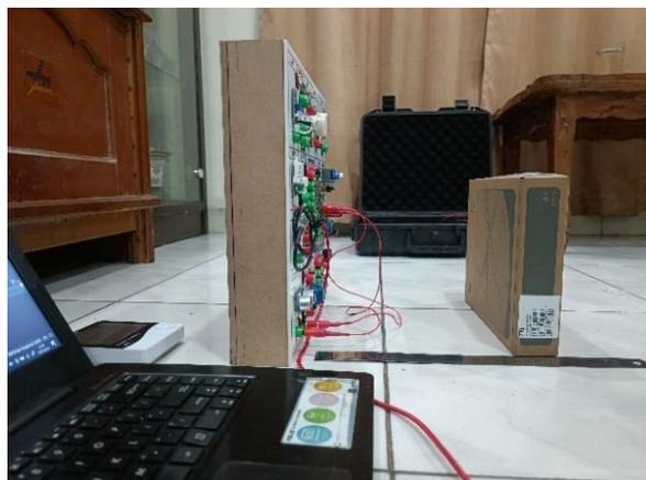
Gambar 3. 11 Pengujian Sensor HC-SR04
