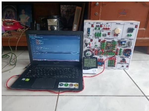
Gambar 3. 5 Pengujian Sensor DHT22
