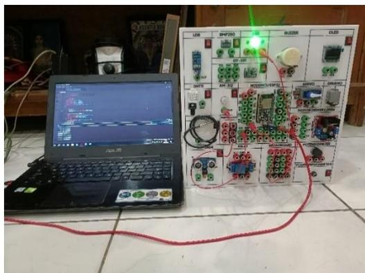
Gambar 3. 7 Pengujian Sensor PIR AM312
