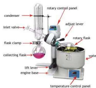
**Gambar 2. 1** Komponen utama *vacuum evaporator*
