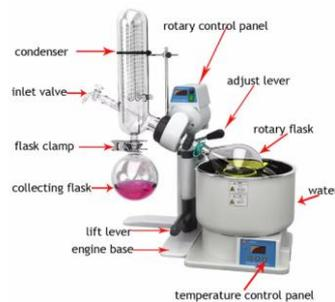
**Gambar 2. 1** Komponen utama *vacuum evaporator*
