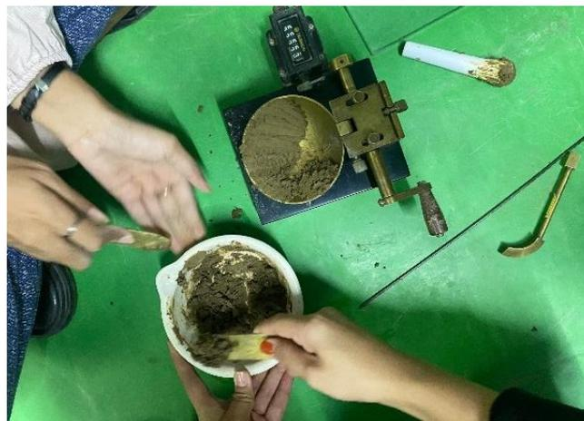
**Gambar 5.6** Pengujian Batas Cair
