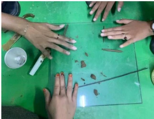
**Gambar 5.8** Pengujian Batas Plastis
