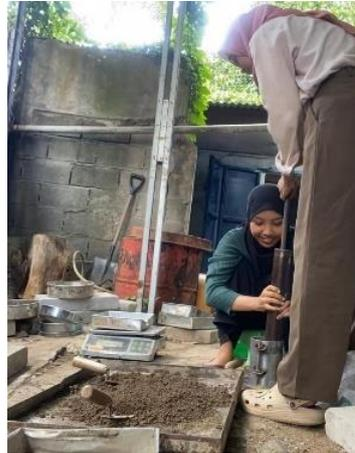
**Gambar 5.16** Pembuatan Sampel Pematatan
