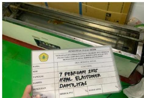
Gambar 5.7 Pengujian Daktilitas Aspal
