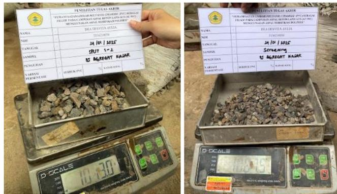
Gambar 5.1 Pengujian Berat Jenis dan Penyerapan Agregat Kasar
