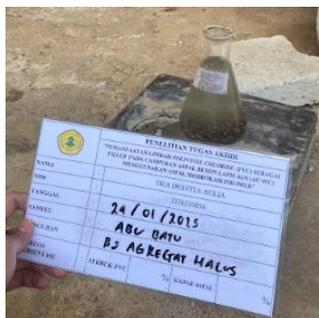
Gambar 5.3 Pengujian Berat Jenis dan Penyerapan Agregat Halus
