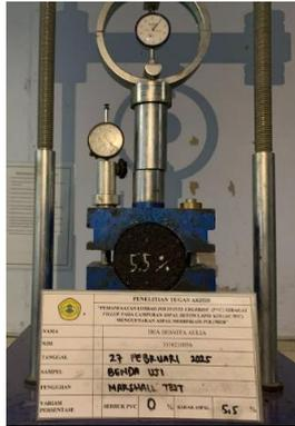
Gambar 5.13 Pengujian dengan Alat *Marshall*
