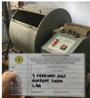
Gambar 5.2 Pengujian Keausan Agregat Kasar
