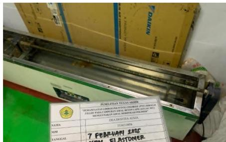
Gambar 4.5 Alat Uji Daktilitas Aspal
