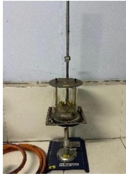
Gambar 4.4 Alat Uji Titik Lembek Aspal
