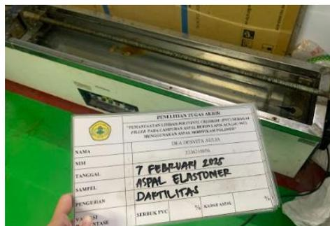
Gambar 5.7 Pengujian Daktilitas Aspal
