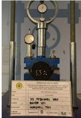
Gambar 5.13 Pengujian dengan Alat *Marshall*
