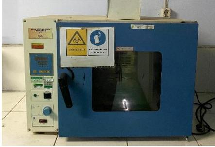
Gambar 4.6 Alat Uji Kehilangan Berat Minyak Aspal
