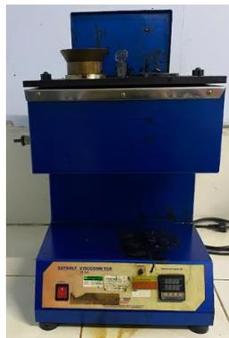
Gambar 5.11 Alat Pengujian Viskositas Aspal
