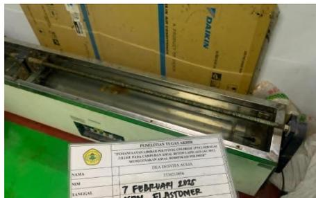
Gambar 4.5 Alat Uji Daktilitas Aspal
