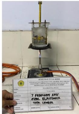
Gambar 5.8 Pengujian Titik Lembek Aspal
