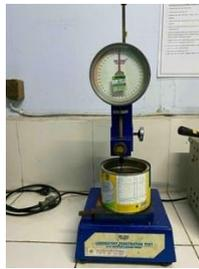
Gambar 4.2 Alat Uji Penetrasi Aspal
