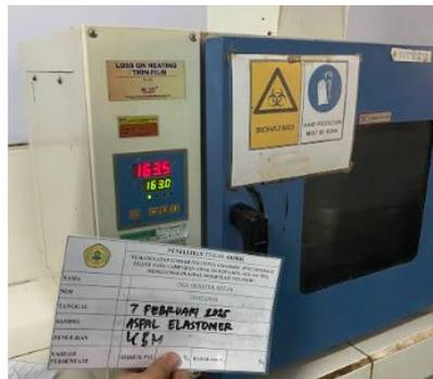
Gambar 5.6 Pengujian Kehilangan Berat Minyak Aspal
