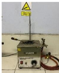
Gambar 4.3 Alat Uji Titik Nyala dan Titik Bakar Aspal
