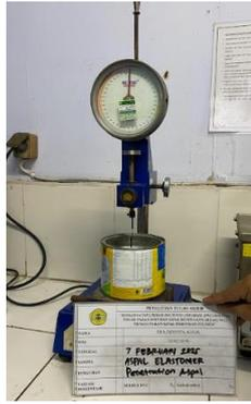
Gambar 5.5 Pengujian Penetrasi Aspal
