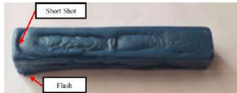
Gambar 4.22 Cacat Pada Balok Paduan Plastik DU Temperatur 200°C
