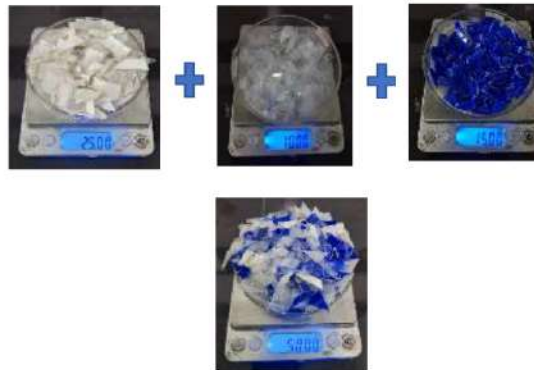
Gambar 3.19 Minimbang Cacahan Limbah Plastik Untuk Sempel Uji Impak
