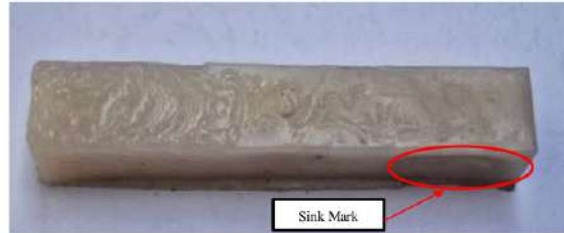
Gambar 4.24 Cacat Pada Balok Paduan Plastik Murni Temperatur 200°C
