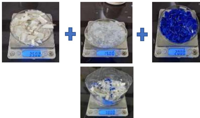
**Gambar 3.18** Minimbang Cacahan Limbah Plastik Untuk *Sampel Uji Tarik*
