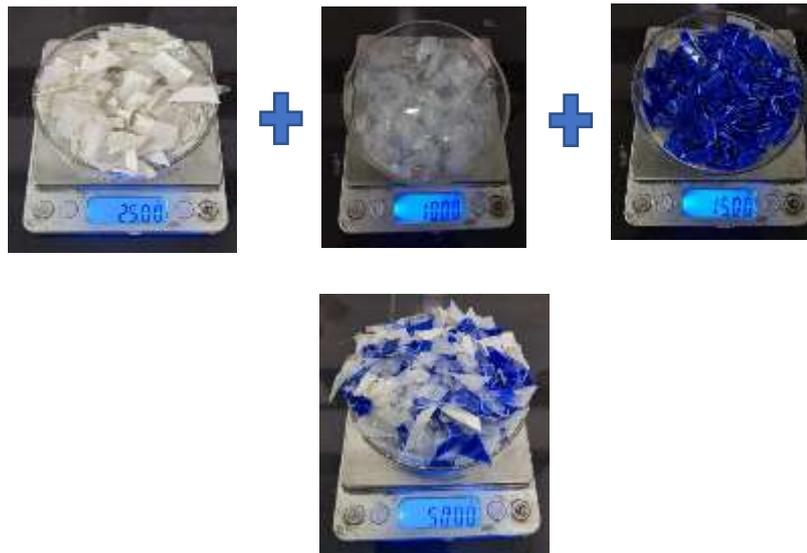
**Gambar 3.19** Minimbang Cacahan Limbah Plastik Untuk *Sampel Uji Impak*
