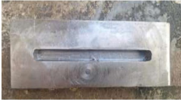
**Gambar 3.5** Cetakan Uji Impak
