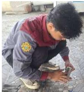
**Gambar 3.22** Mengoleskan Minyak Goreng Pada Cetakan
