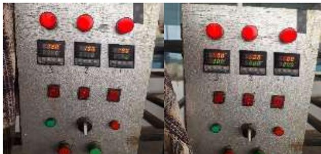
**Gambar 3.23** Mengatur Suhu Pada Mesin *Injection Molding*
