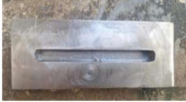
**Gambar 3.5** Cetakan Uji Impak
