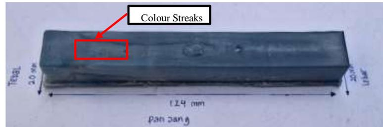
**Gambar 4.21** Cacat Pada Balok Paduan Plastik DU Temperatur 190°C
