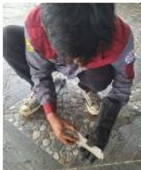
**Gambar 3.26** Mengeluarkan *Sampel* Dari Cetakan
