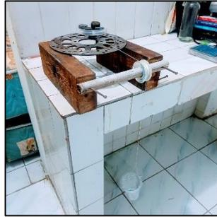
**Gambar 3.10** Instrument pengukuran koefisien gesek
