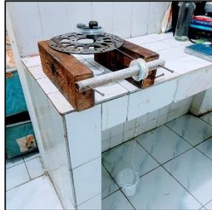
**Gambar 3.10** Instrument pengukuran koefisien gesek
