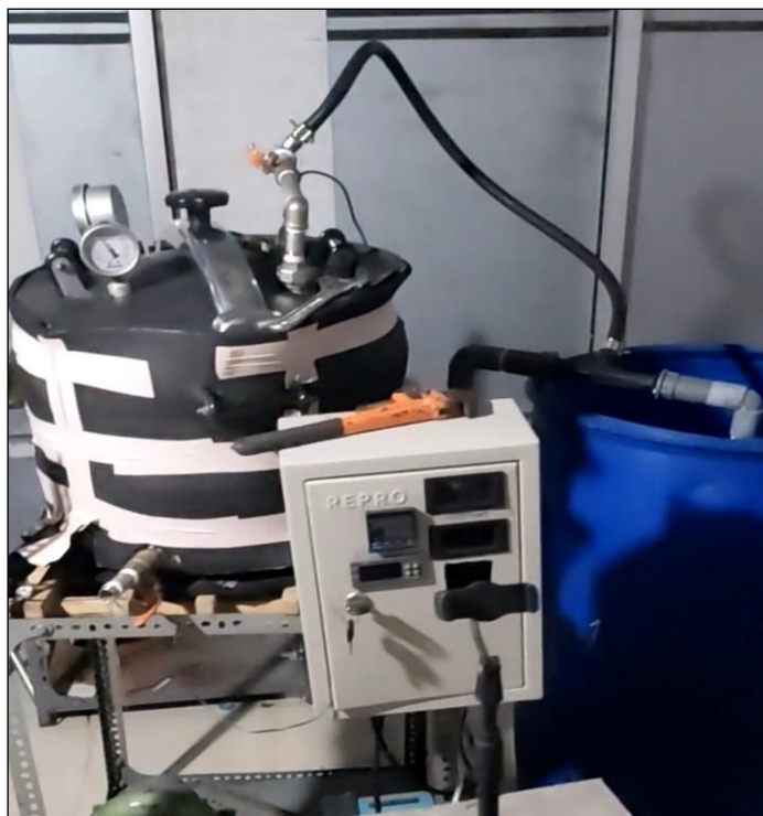
Gambar 4.1 Vacuum Evaporator dengan Pressure Controller
