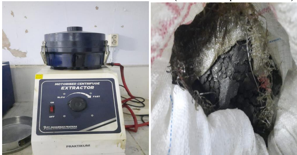
Gambar 3.3 Gambar alat dan bahan RAP ( Reclaimed Asphalt Pavement )
