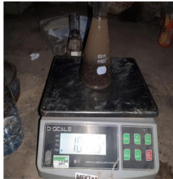
Gambar 5.18 Pengujian Berat Jenis Agregat Halus RAP
