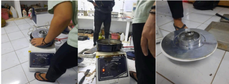
Gambar 5.15 Pengujian Ekstrasi Aspal
