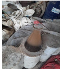
Gambar 5.19 Pengujian Penyerapan Agregat Halus RAP
