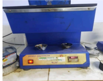
Gambar 5.13 Pengujian viskositas Aspal
