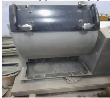
Gambar 5.3 Pengujian Keausan Agregat Kasar
