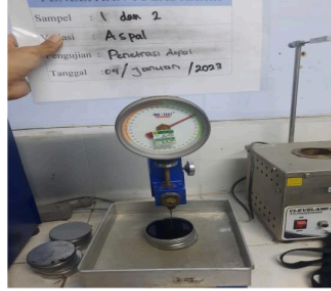
Gambar 5.10 Pengujian Penetrasi Aspal
