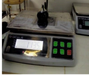
Gambar 5.8 Pengujian Berat Jenis Aspal
