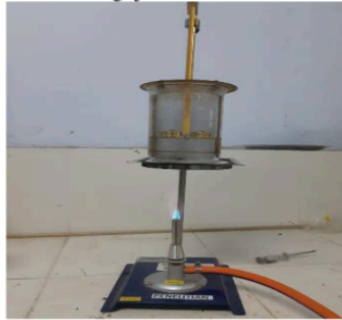
Gambar 5.9 Pengujian Titik Lembek Aspal
