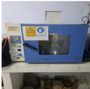
Gambar 5.11 Pengujian Kehilangan Berat Aspal
