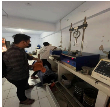
Gambar 5.22 Pengujian Marshall Test
