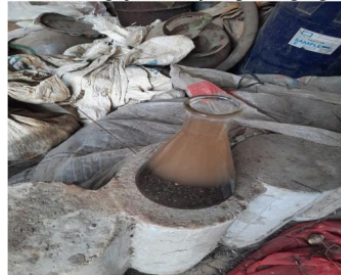
Gambar 5.6 Pengujian Penyerapan Agregat Halus
