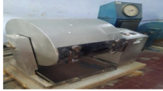
Gambar 5.17 Pengujian Keausan Agregat Kasar RAP
