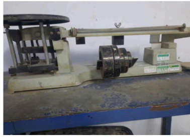
Gambar 5.16 Pengujian Berat Jenis Agregat Kasar RAP
