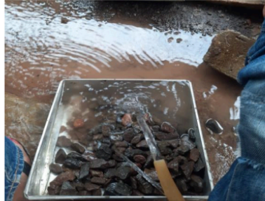
Gambar 5.2 Pengujian Penyerapan Agregat Kasar
