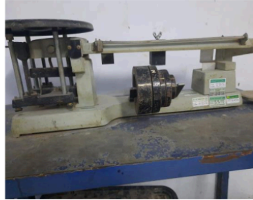
Gambar 5.1 Pengujian Berat Jenis Agregat Kasar
