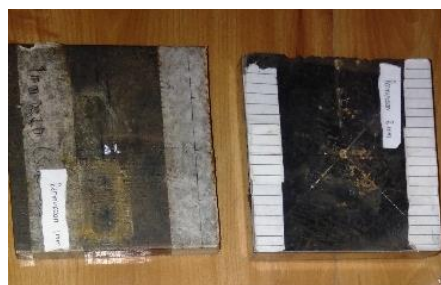
Gambar 3.4 Sampel Pelat Baja 1 dan 3 mm.
