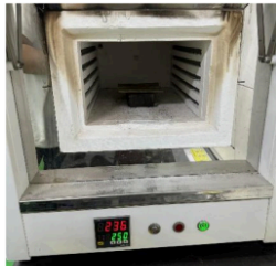
Gambar 3.30 Proses pemaparan panas 250°C
