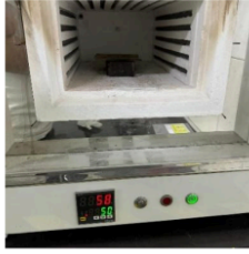
Gambar 3.28 Proses pemaparan panas 50°C
