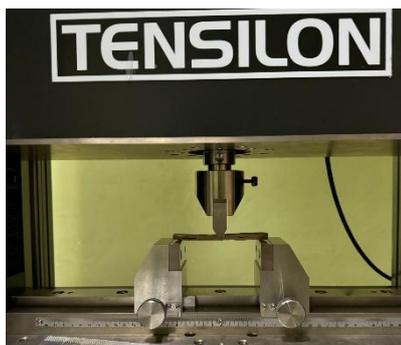
**Gambar 3.36** Pengujian kekuatan lentur
