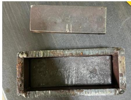
**Gambar 3.3** Cetakan papan partikel
