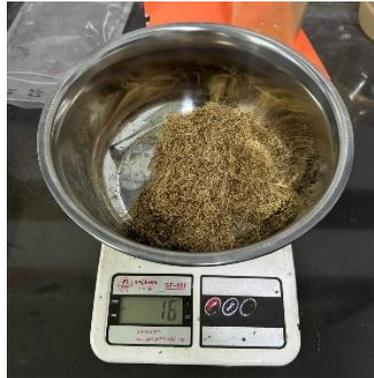
**Gambar 3.20** Penimbangan serat mesokarp kelapa sawit
