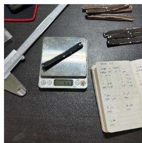
**Gambar 3.32** Proses pengujian kerapatan
