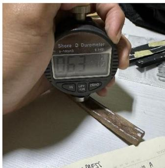
**Gambar 3.35** Proses pengujian kekerasan
