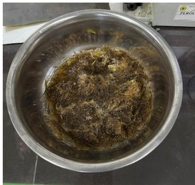
**Gambar 3.18** Alkalisasi serat mesokarp kelapa sawit
