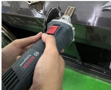
**Gambar 3.26** Proses pemotongan papan partikel
