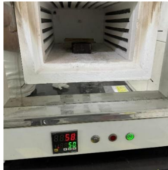
Gambar 3.28 Proses pemaparan panas 50°C
