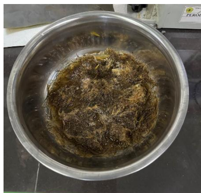
Gambar 3.18 Alkalisasi serat mesokarp kelapa sawit
