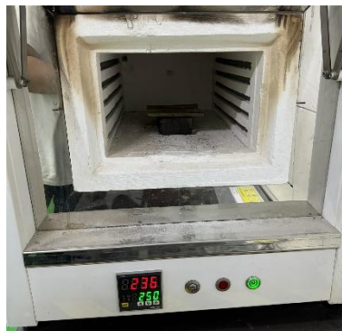
Gambar 3.30 Proses pemaparan panas 250°C
