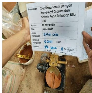
Gambar 5.7 Pengujian Batas Cair Tanah
