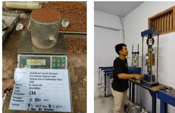
Gambar 5.25 Pengujian CBR
