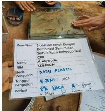
Gambar 5.9 Pengujian Batas Plastis Tanah
