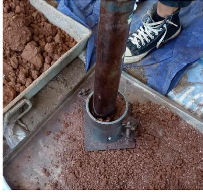
Gambar 5.11 Pengujian Pemadatan
