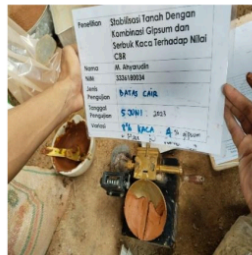
Gambar 5.7 Pengujian Batas Cair Tanah
