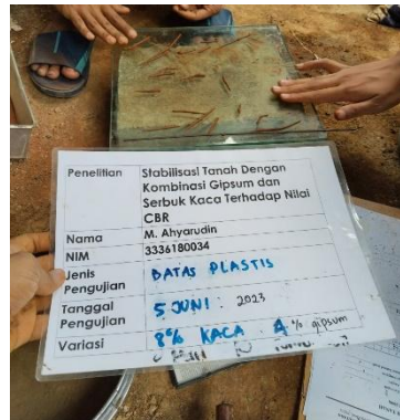
Gambar 5.9 Pengujian Batas Plastis Tanah
