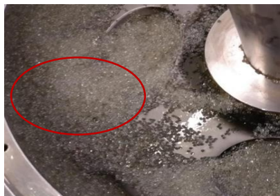
Gambar 4.5 Proses Pergantian Glass Blead (Sumber : Dokumen Pribadi)
