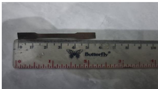
Gambar 3. 4 Spesimen Penelitian Setelah Dilakukan Perlakuan Panas
