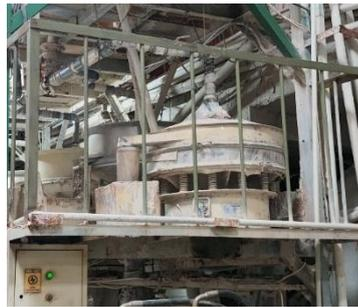
**Gambar 2.17** Mesin saringan getar
