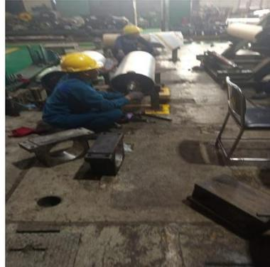
**Gambar 5.1** Proses Pelepasan komponen *deflector roll*
