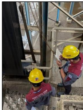
**Gambar 4.5** *Inspeksi Visual pada Jalur Belt Conveyor*
