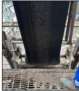
**Gambar 4.10** *Belt Conveyor* sudah tidak *Mistracking*
