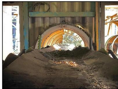
**Gambar 4.1** *Belt Conveyor* pada Unit 5 - 7
