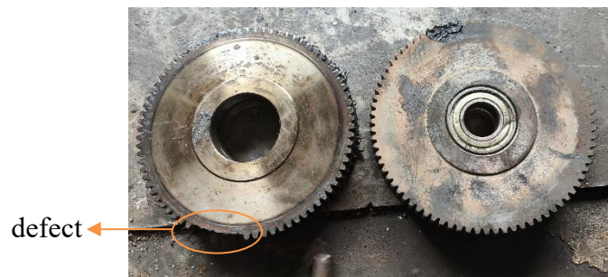
Gambar 4.7 (a) Idle Gear Lama dan (b) Idle Gear Baru
