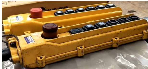
Gambar 4.13 (a) Pendant Controller Lama (b) Pendant Controller Baru
