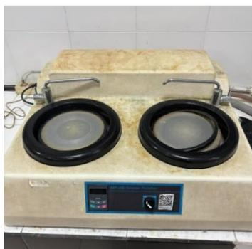
**Gambar C.15** *Mesin Grinding dan Polishing*
