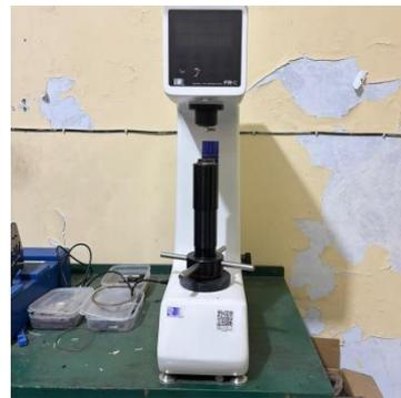
**Gambar C.4** Alat Uji Kekerasan
