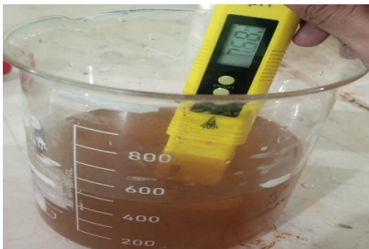
Gambar C.3 Air Limbah Setelah Penambahan NaOH
