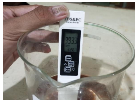
Gambar C.10 Pengujian Parameter TDS
