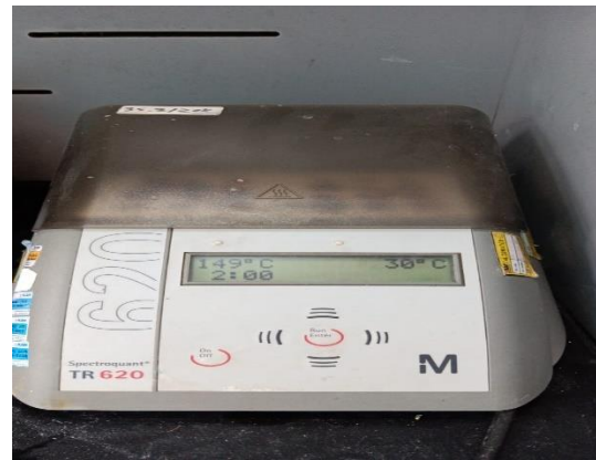
Gambar C.12 Pengujian Parameter COD
