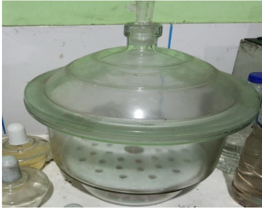
Gambar C.11 Pengujian Parameter TSS
