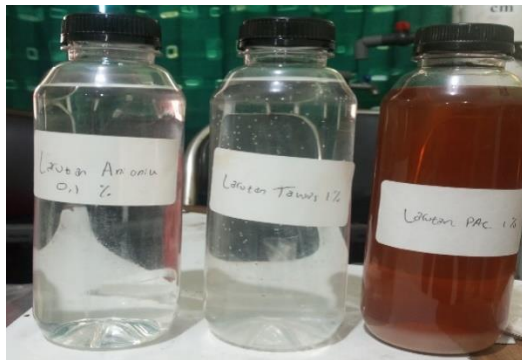
Gambar C.5 Pembuatan Larutan Koagulan Flokulan
