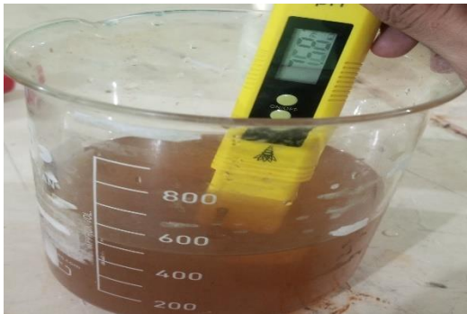
Gambar C.3 Air Limbah Setelah Penambahan NaOH
