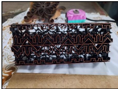
Gambar 10. Canting Batik Cap Tembaga PT Batik Banten Mukarnas
