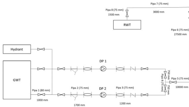
**Gambar 4.5** Skema Pipa Air Bersih
