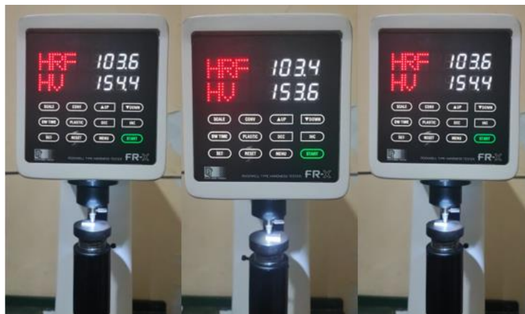
Gambar B.9 Hasil Uji Kekerasan Sampel I (80A20K) Dengan Waktu Tahan 4 Jam
