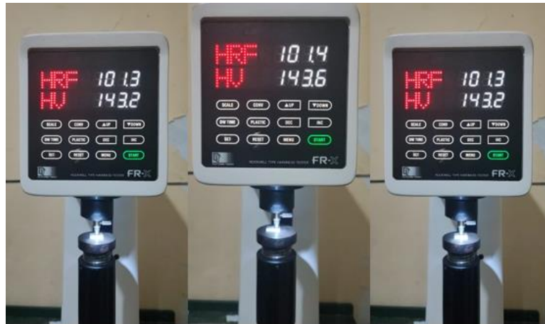
Gambar B.4 Hasil Uji Kekerasan Sampel D (70A30K) Dengan Waktu Tahan 2 Jam
