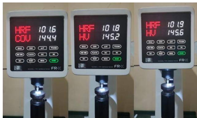
Gambar B.2 Hasil Uji Kekerasan Sampel B (60A40K) Dengan Waktu Tahan 3 Jam
