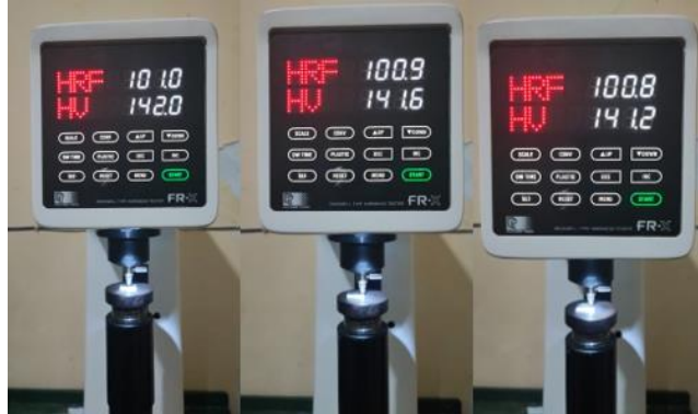
Gambar B.1 Hasil Uji Kekerasan Sampel A (60A40K) Dengan Waktu Tahan 2 Jam
