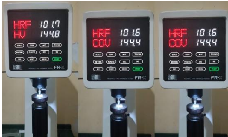
Gambar B.7 Hasil Uji Kekerasan Sampel G (80A20K) Dengan Waktu Tahan 2 Jam
