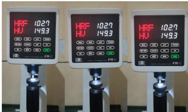
Gambar B.8 Hasil Uji Kekerasan Sampel H (80A20K) Dengan Waktu Tahan 3 Jam
