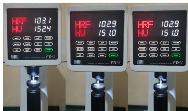
Gambar B.3 Hasil Uji Kekerasan Sampel C (60A40K) Dengan Waktu Tahan 4 Jam
