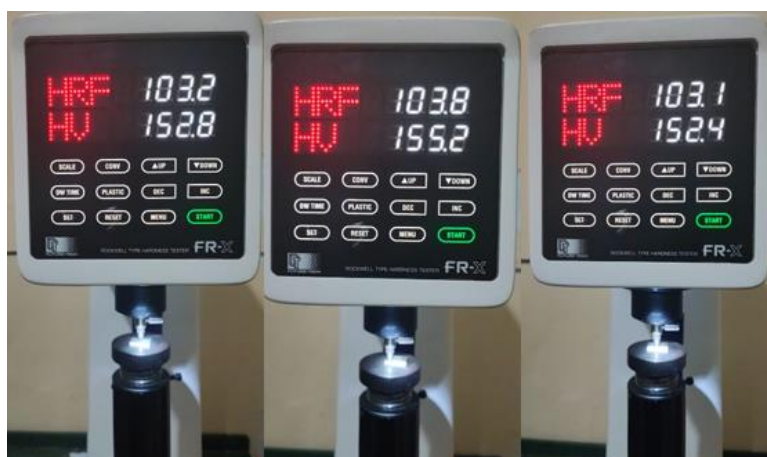
Gambar B.6 Hasil Uji Kekerasan Sampel F (70A30K) Dengan Waktu Tahan 4 Jam
