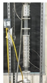
Gambar E.6 Kolom flotasi
