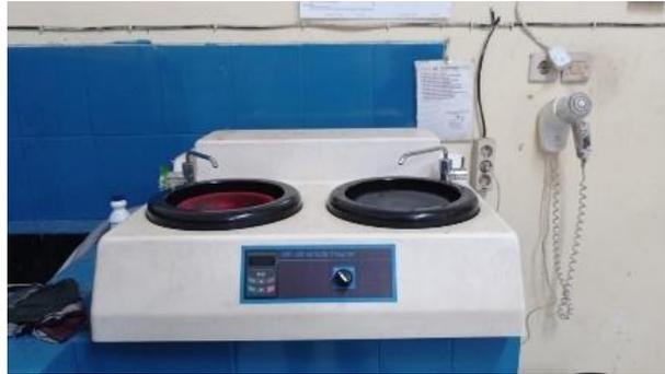
**Gambar C.7** Mesin Poles
