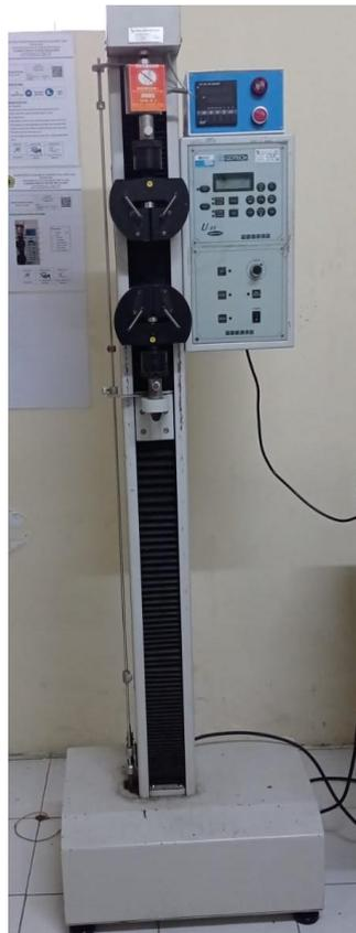
**Gambar C.10** Mesin Uji Tarik
