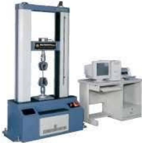
**Gambar 3.7** Mesin Uji Tarik
