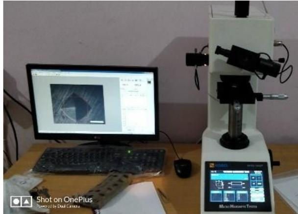
**Gambar C.9** Mesin Uji Kekerasan
