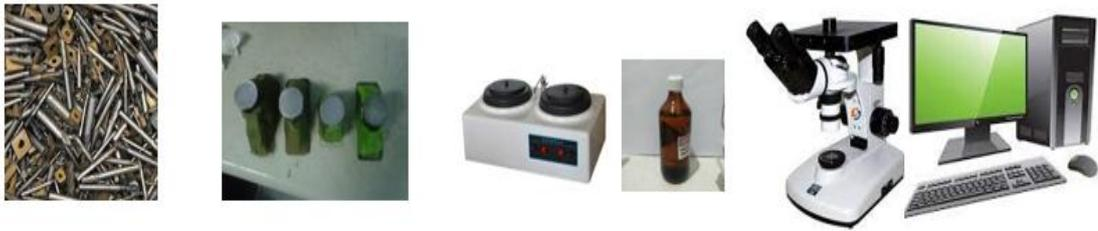
**Gambar 2.9** Alat dan Bahan Yang Dibutuhkan Dalam Proses Metalografi
