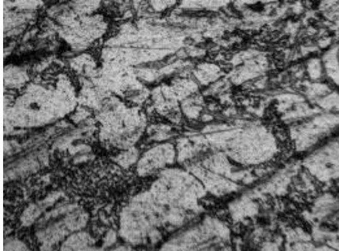
Gambar 2.10 Hasil Metalografi Alimunium 7075 Belum Diproses Mekanik
