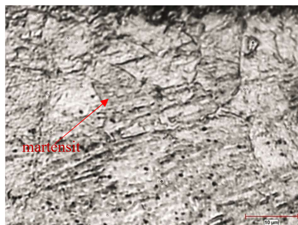
Gambar 4.11 Struktur Mikro Sampel Water Cooling Hasil Pemanasan 900°C
