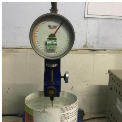
**Gambar 4.2** Pengujian Penetrasi Aspal
