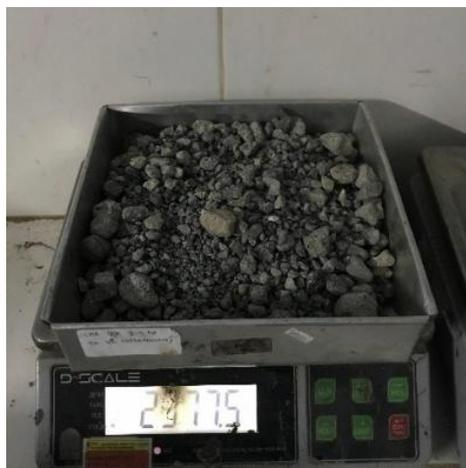
**Gambar 4.1** Pengujian Keausan Agregat Alam dengan Mesin LAA
